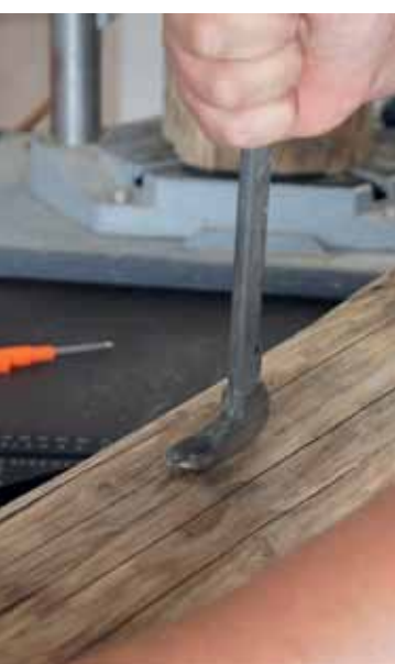
alte Nägel werden gezogen
