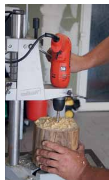
Löcher werden gebohrt
